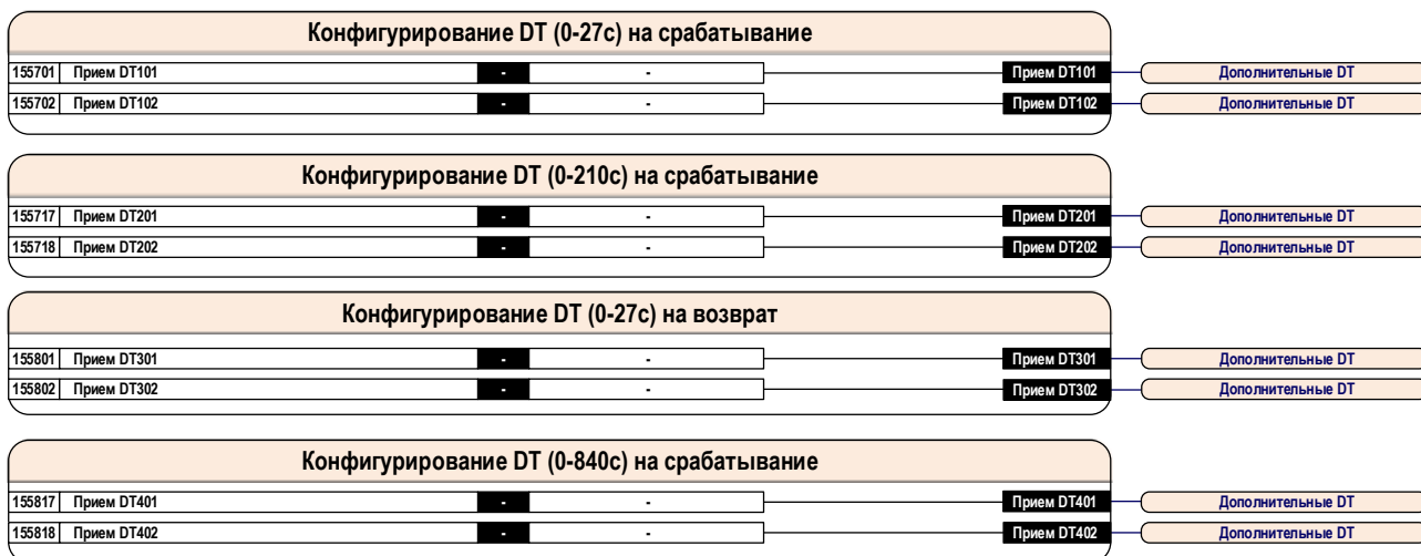
Рисунок 8.280 – Конфигурирование дополнительных выдержек времени терминала БЭ2704 600
