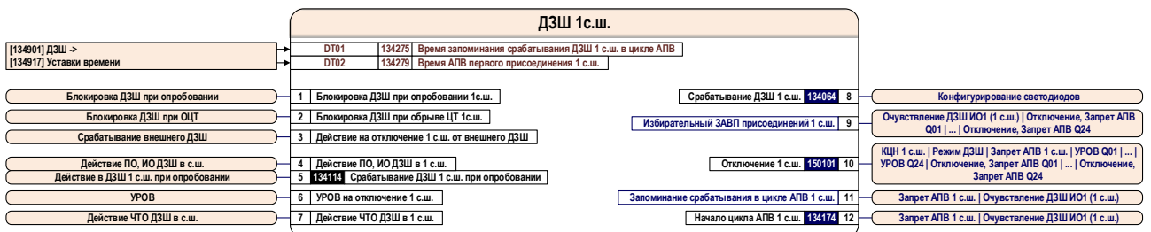
Рисунок 8.52 – Блок-схема ДЗШ 1 с.ш. терминала БЭ2704 403
