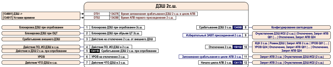
Рисунок 8.53 – Блок-схема ДЗШ 2 с.ш. терминала БЭ2704 403
