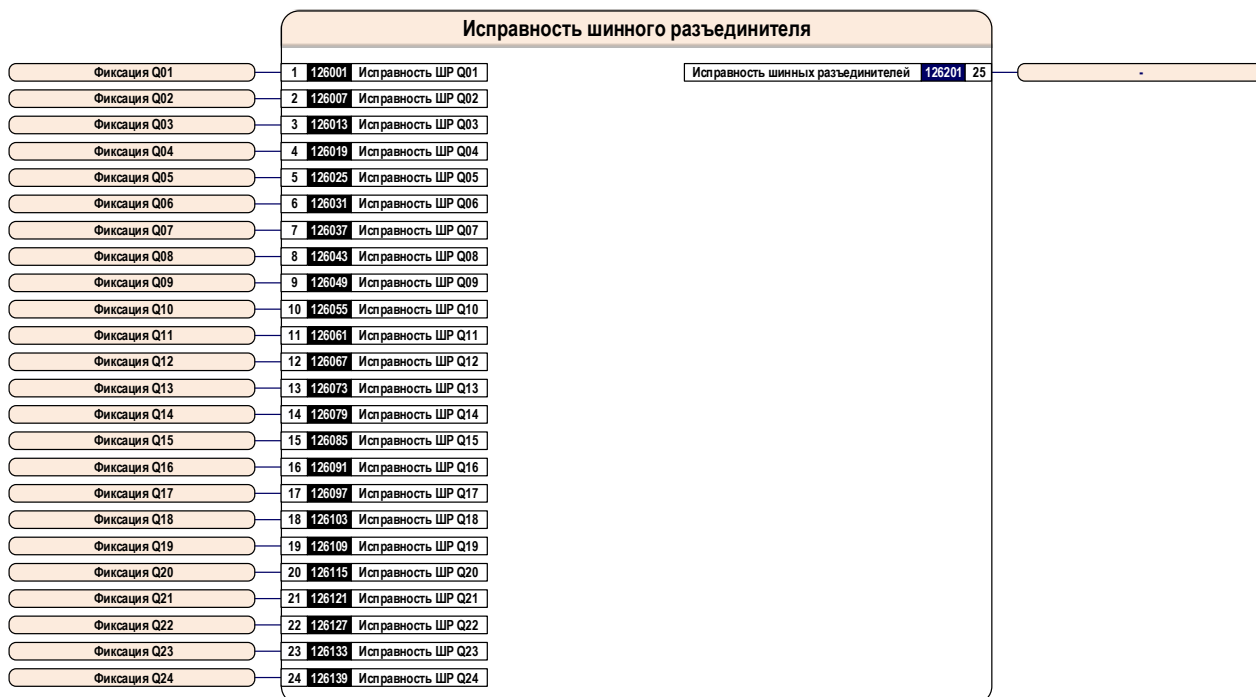
Рисунок 8.222 – Блок-схемы исправности шинного разъединителя терминала БЭ2704 600
